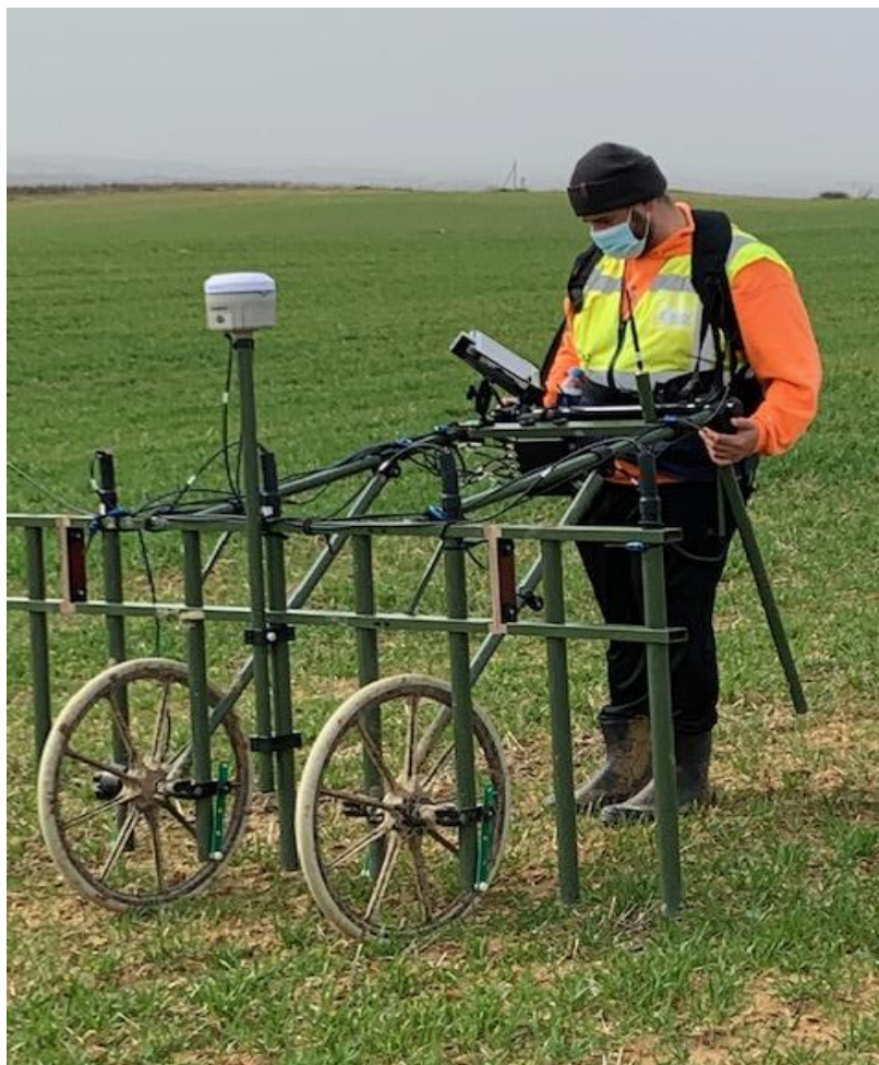
Trabajos de prospección geomagnética del as fincas de la antigua ciudad de Lancia.
